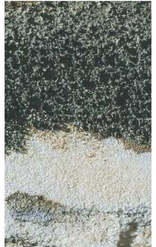
Διάφορες επικαθίσεις, αποτέλεσμα της ατμοσφαιρικής ρύπανσης. Διακρίνονται οι κόκκοι του μαρμάρου που έχουν χάσει τη συνοχή τους και σχηματίζουν κρούστα σκουρόχρωμη από την αιθάλη και τη σκόνη.
