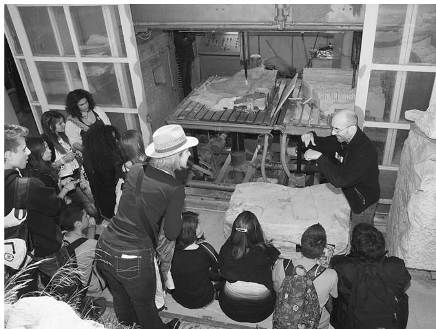
Εργαστήριο για τη χρήση παντογράφου για την κατασκευή συμπληρωμάτων από νέο μάρμαρο. Φωτ. Τ. Σουβλάκης, 2012
